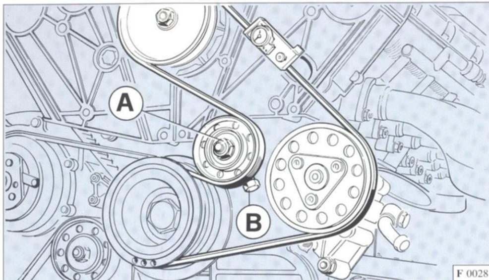
Fig. 25 - Tensione cinghia comando pompa acqua e pompa guida idraulica.
