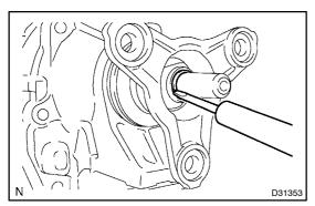
7. REMOVE AUTOMATIC TRANSMISSION FLANGE YOKE ASSY
