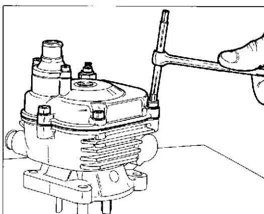
Svitare le cinque viti di fissaggio coperchio testa e rimuovere quest'ultimo recuperando la guarnizione e l'anello OR centrale di tenuta sul mozzo candela.
