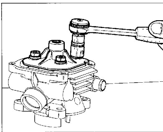
Svitare i quattro dadi di bloccaggio testa al cilindro e sfilare questo elemento unitamente alla guarnizione OR.
