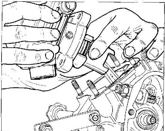
Extraire le groupe thermique des prisonniers du soubassement en supportant le piston une fois qu'il est sorti du cylindre. Récupérer les deux plaques d'ancrage ressorts, les deux rondelles et la garniture.
